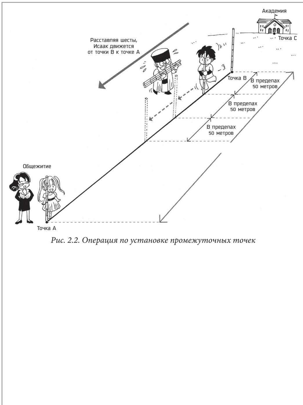
Рис. 2.2. Операция по установке промежуточных точек
