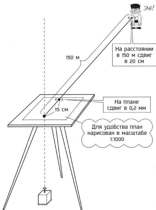
Рис. 4.7. Невязки при мензурной съемке
