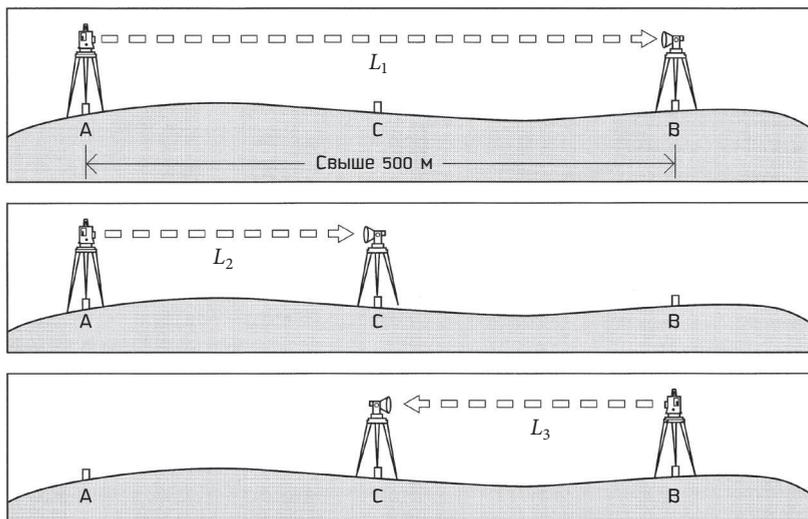
Рис. 2.8. Способ нахождения константы прибора у светодальномера
