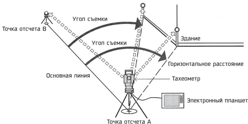
Рис. 4.12. Мензуральная съемка с помощью электронных приборов
