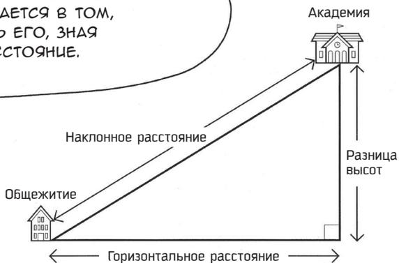
Искомое расстояние можно вычислить, зная наклонное расстояние и разницу высот
