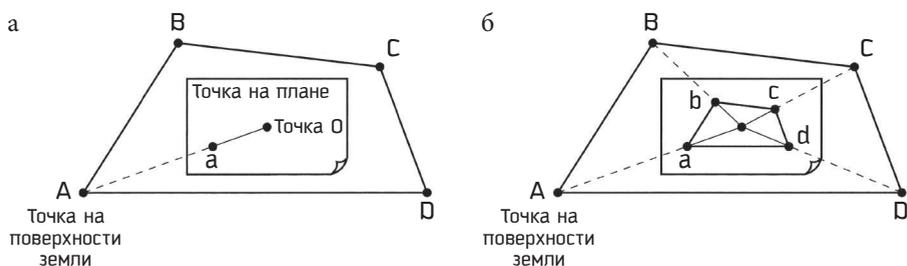
Рис. 4.9. Контурная съемка способом полярных координат:
