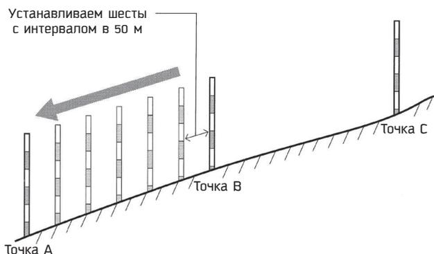
Рис. 2.3. Завершение установки промежуточных точек
