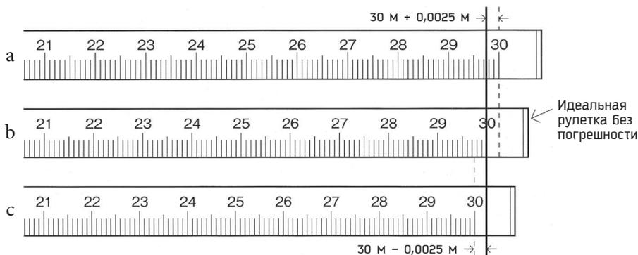
Рис. 2.6. Компарирование рулетки
