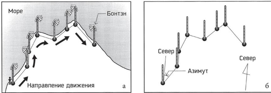
Рис. 1.17. Метод съемки, используемый Тадатака:
