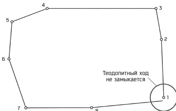
Рис. 3.24. Невязка замкнутого теодолитного хода
