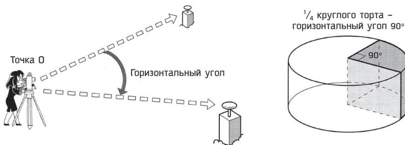
Рис. 3.5. Горизонтальный угол
