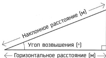
Рис. 3.7. Отношение между горизонтальным и наклонным расстояниями
