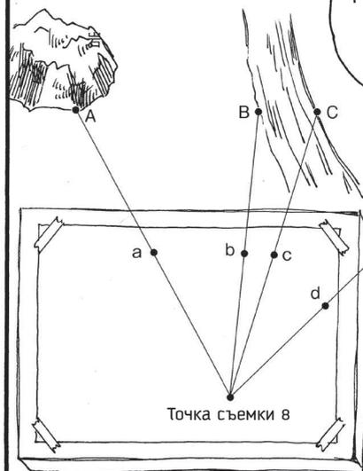
Измеряем расстояние до ближайшей точки на поверхности земли. Если угол здания вертикален, визируем его. Если здание пирамидальной формы, то устанавливаем на поверхности земли шесты на границе с ним и визируем эти шесты.
