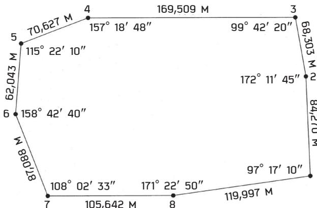
Рис. 3.8. Приведенные углы и расстояния замкнутого хода
