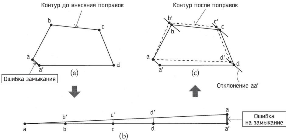
Рис. 4.11. Внесение поправок при съемке способом засечек
